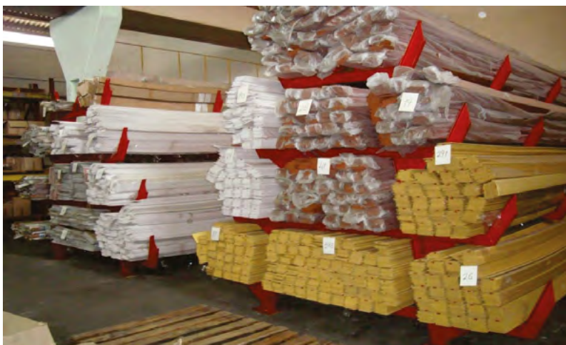
Fig. 1.4. Estantería especializada utiliza para el almacenamiento de madera y otras cargas largas, manipulación manual.
