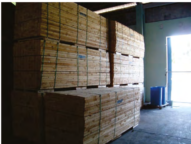
Fig. 2.4. Cenefa tecnológica doble para madera en estiba directa, manipulación mecanizada.
