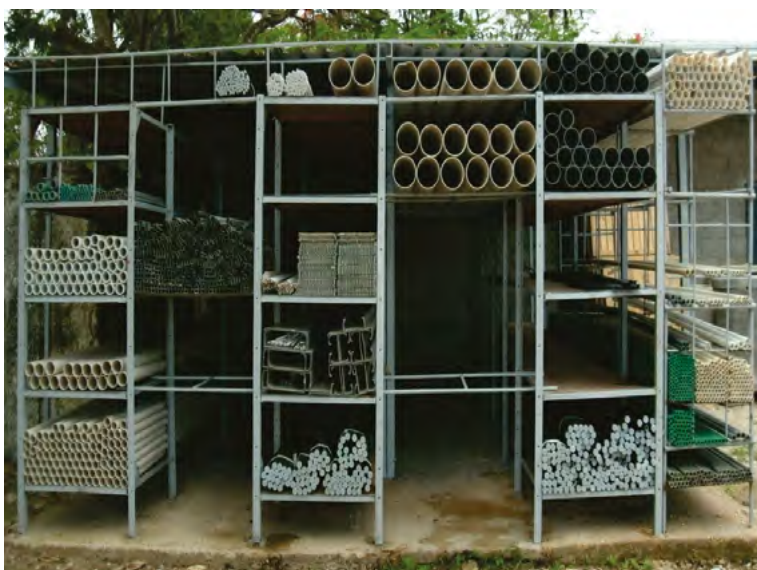
Fig. 2.9. Cunitas tecnológicas entre estanterías utilizada para cargas largas y como nave autoportante.
