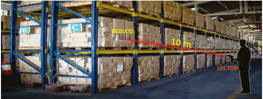
Fig. 6.5. Ejemplo de lectura con pistola de identificación por radio frecuencia o RFID.
