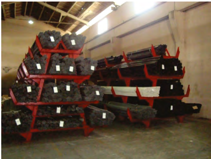
Fig. 1.3. Estantería especializada para cargas largas utilizada con cargas ligeras, manipulación manual.
