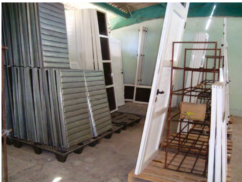
Fig. 2.6. Estiba directa flexible auxiliada por estanterías para carga fraccionada montadas sobre paletas al igual que el producto.
