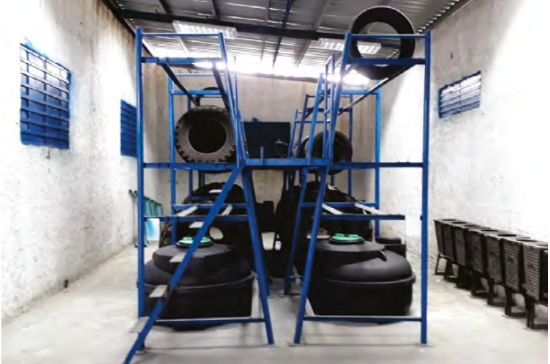
Fig. 3.7. Estantería especializada para neumáticos del tipo “Limonar”.
