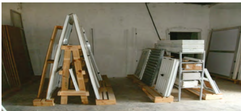
Fig. 2.5. Estiba directa flexible, auxiliada por burros o estanterías para fraccionada apoyado el producto sobre plataformas de carga.
