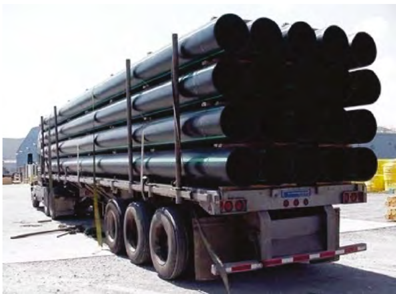
Fig. 3.2. Vehículo cargado con tuberías plásticas y ejemplificación de separadores y trincaje.
