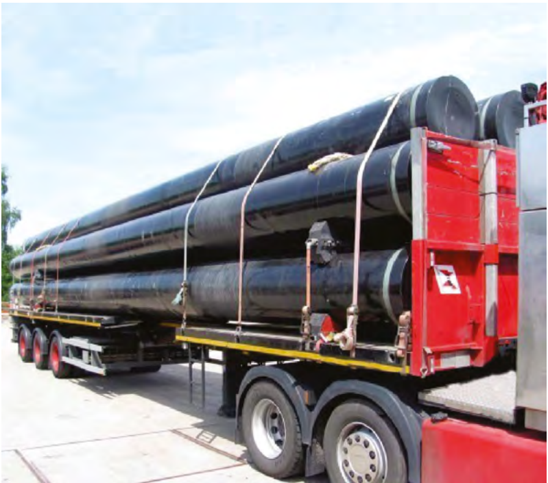
Fig. 3.1. Vehículo de transportación de cargas largas de 12 o más metros.
