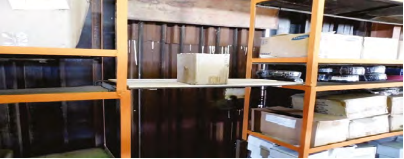
Fig. 2.7. Cunita tecnológica entre estanterías para carga fraccionada.
