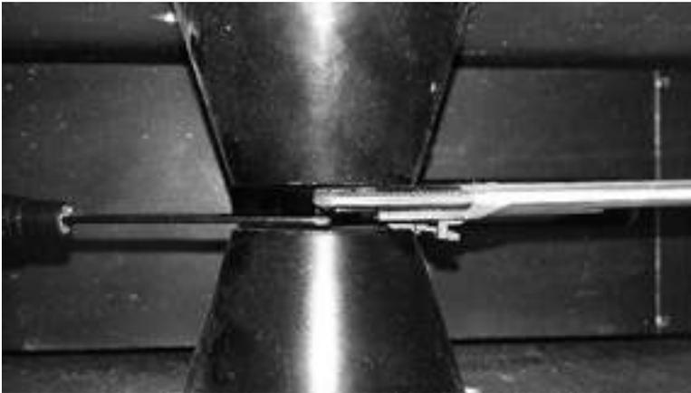
**Figura 3.** Vista superior con los detalles de la ubicación del sensor Hall del dispositivo desarrollado (encima) y del sensor del militeslámetro (debajo) en los polos del electroimán.
