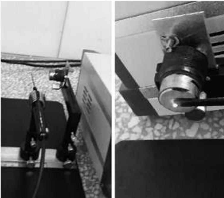
**Figura 2.** Detalles del montaje para garantizar las mediciones del campo magnético sobre el eje que pasa por el centro del imán.
