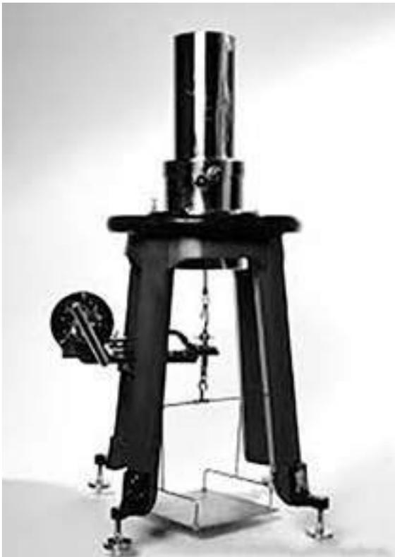
**Figura 3.** Electrómetro piezoeléctrico de cuarzo diseñado por Pierre Curie y su hermano Jacques.
