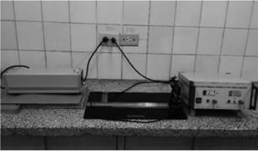
**Figura 1.** Montaje experimental para determinar el momento magnético del imán a través de su relación con la magnitud del campo que genera.
