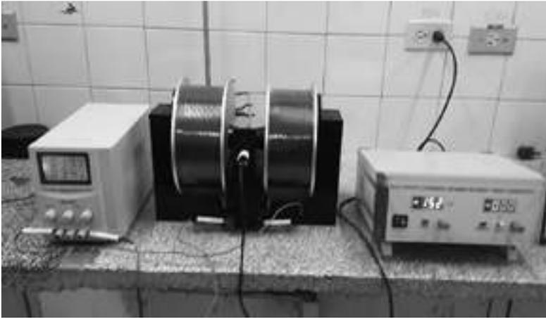
**Figura 2.** Montaje para la construcción de la característica de transferencia del sensor UGN 3503.
